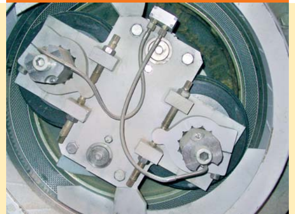
Robuste Stahlwalzen (Koller) pressen die Holzspäne durch die Matrize Quelle: Bühler AG, Uzwil, Schweiz
