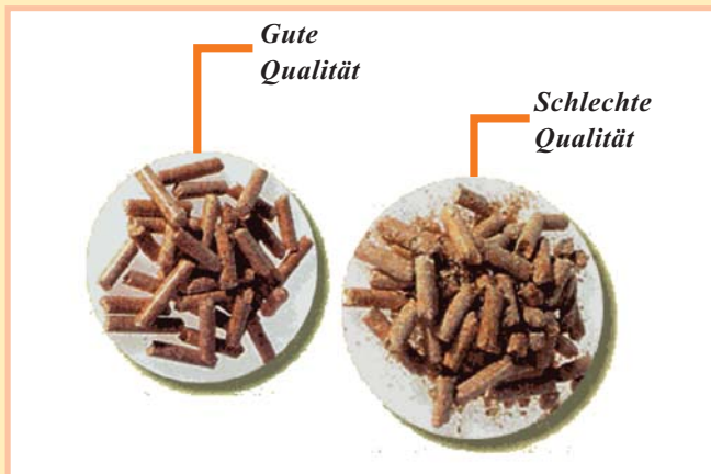
Vergleich von Pellets mit guter und schlechter Qualität Bild: Umdasch, Amstetten Österreich
