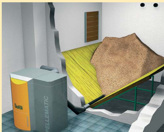
Beispiel für einen Pelletlagerraum Foto: ÖkoFEN, Lembach Österreich
