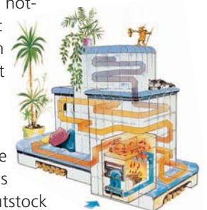
Schematische Zeichnung eines Grundkachelofens
